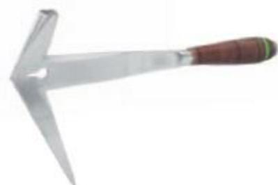
der Wetenschliff befindet sich nur auf einer Seite, für beidseitige Arbeiten an der Haubrücke rechts- und linksseitig, Nagelzieher, handgeschmiedet, verlängerter Ledergriff, blank geschliffen, Kopf, Spitze und Waten induktiv gehärtet, Spitzenschutz, zum Patent angemeldet!
