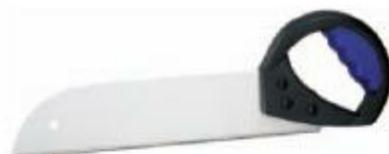
Zähne präzisionsgeschränkt, ausgeschliffen/Kreuzschliff, PATENT-HOHLSCHLIFF, kaltgewalzter Edelbandstahl, 2-Komponenten-Komfort-Handgriff, mit Anschlagwinkel 45° und 90°
