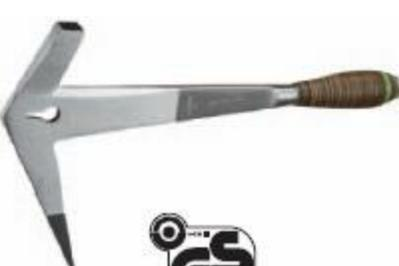
Nagelzieher, handgeschmiedet, Ledergriff, blank geschliffen, Kopf, Spitze und Waten induktiv gehärtet, Spitzenschutz
